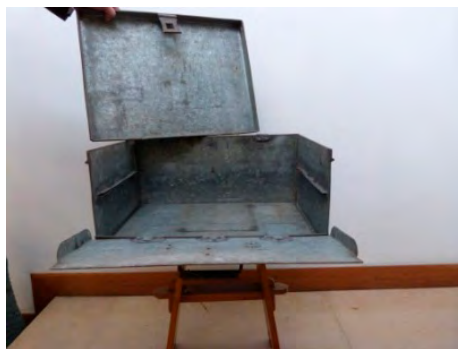
Fig. 5 – Mala de folha para o transporte dos cartões com ouro. Este utensílio apresentava uma abertura superior e frontal para permitir a colocação dos cartões nos quais o ouro era cosido. Imagem cedida por Carlos Tavares.
